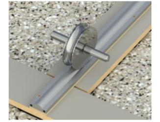
Instalação de trilhos para deslizamento dos módulos
